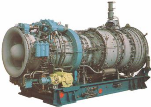
Електростанція ЕГ-15000 на базі ГТД «ДБ90»
